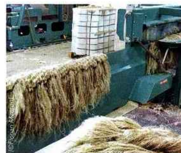
La fabrication des isolants en lin passe par des opérations de cardage, de thermolignage, de séchage, d'aération et de découpe.
